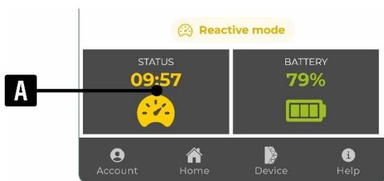
**A:** Indica che la frequenza di connessione è quella della modalità reattiva. Permette di sapere quando il dispositivo Nuvola+ è in modalità reattiva e fino a quando.
