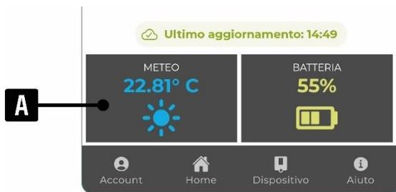
**A:** Temperatura e previsioni meteo relative alla posizione impostata, una volta abilitata la funzione pausa meteo.
